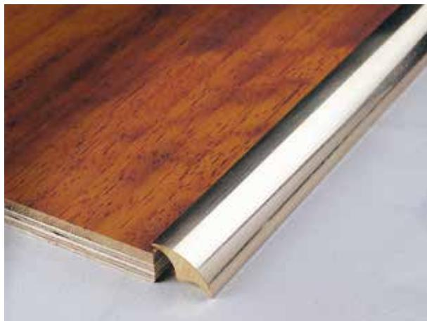
La caratteristica dei profili VARIOTEC DC consiste nella possibilità di adattamento a differenti dislivelli, grazie alla particolare forma del profilo a mezzaluna che, ruotando, si adatta a spessori compresi tra 7 e 14 mm di altezza, pur mantenendo una superficie in vista assai ridotta ed elegante. L'installazione del profilo avviene tramite adesivo da applicare in opera, riempendo completamente la cavità che si crea tra pavimento e profilo.
